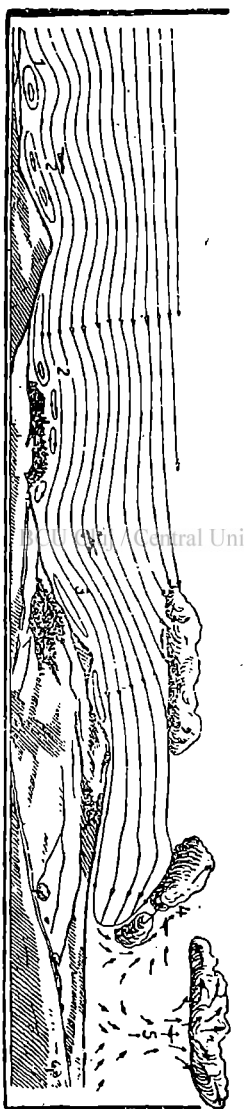
Fi. 8. Formarea curenților ascendenți: 1, vârtej local; 2, ascendență produsă de o movilă; 3, ascendență produsă de o colină; 4, în fața unei furtuni; 5, sbor sub cumulus.
