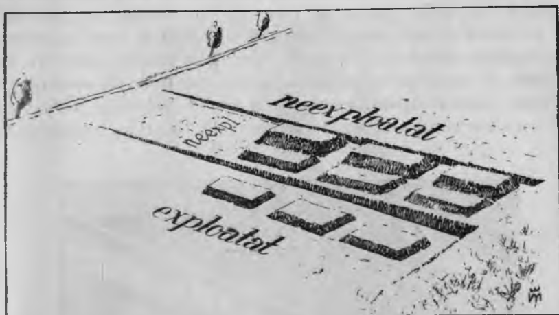
Fig. 5. Schema exploatării în 1927 la Colăcel cu „figurile“ de turbă.
