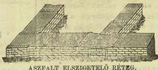
ASZFALT ELSZIGETELŐ RÉTEG.
