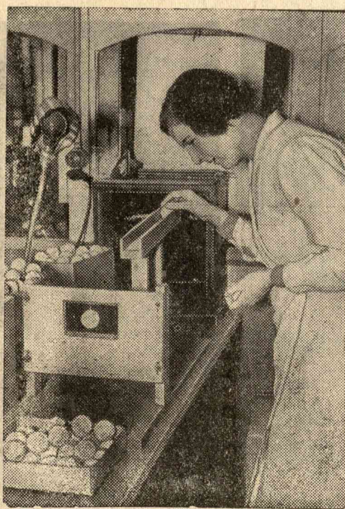
MÉRIK A BILLIÁRD LABDÁKAT. A billiárd labdánál rendkívül fontos azoknak rugalmassága. Képünkön egy ilyen rugalmasságmérő szerkezetet mu- tatunk be.
