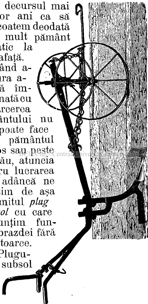
Plugul „Sack“ schimbat în plug subsol prin aceea, că corpul de arat s'a înlocuit cu corpul de plug subsol. (Propper Samu, Budapesta, V. Váczi-körut 52).
