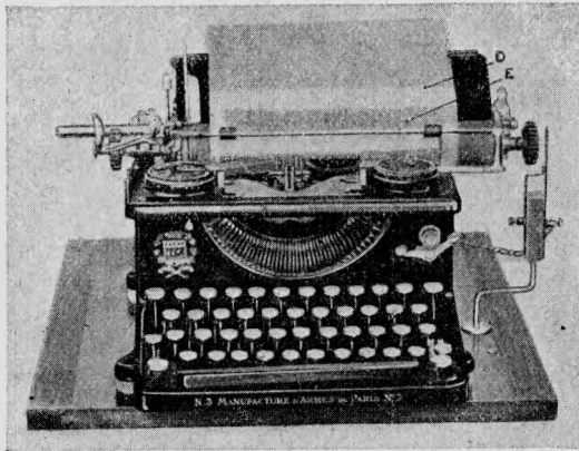
Fig. 4. Mașină de scris echipată pentru înregistrarea mișcărilor carului
